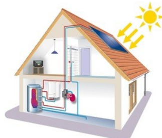
Installazione collettori solari ACS
