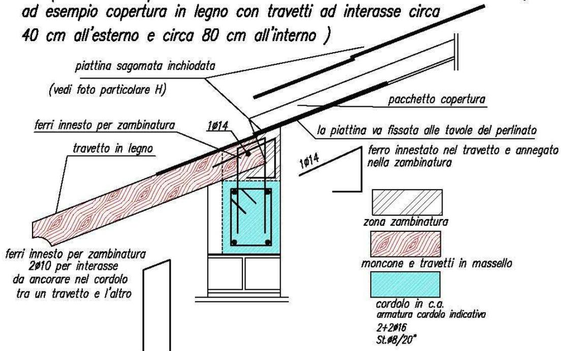
( nel caso di punte di travetti in legno all'esterno + solaio in latero-cemento all'interno, nello spessore del cordolo )
