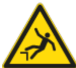
PERICOLO DI CADUTA CON DISLIVELLO
