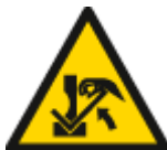
PERICOLO SCHIACCIAMENTO MANI TRA LA PRESSA E IL MATERIALE
